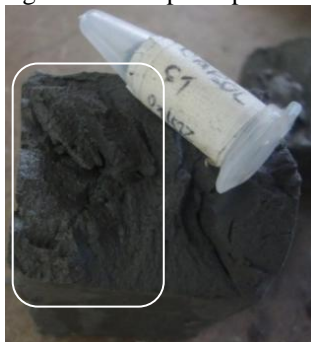
Figura 49 - Corpo de prova de 'C' após ruptura à compressão, 1 dia.
