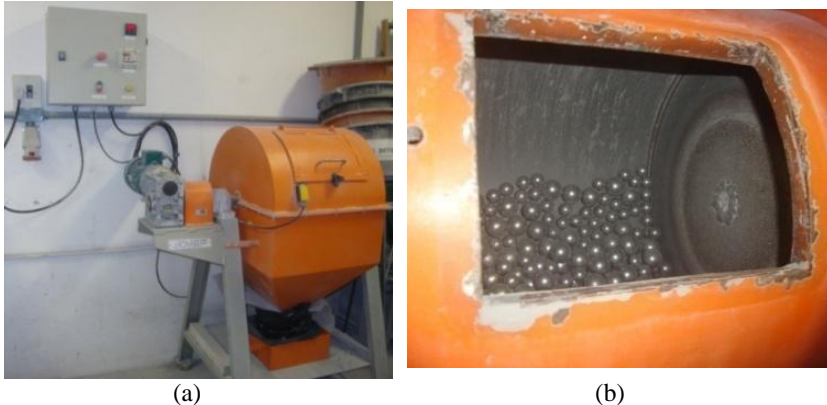
Figura 13 - Moinho de bolas AMEF (a) Apresentação geral; (b) Detalhe interno.
