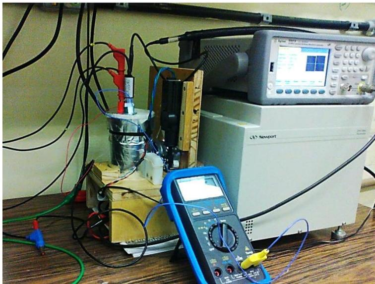
**Figura 47 – Aparato experimental para medidas *PEC*, projetado neste trabalho.**
