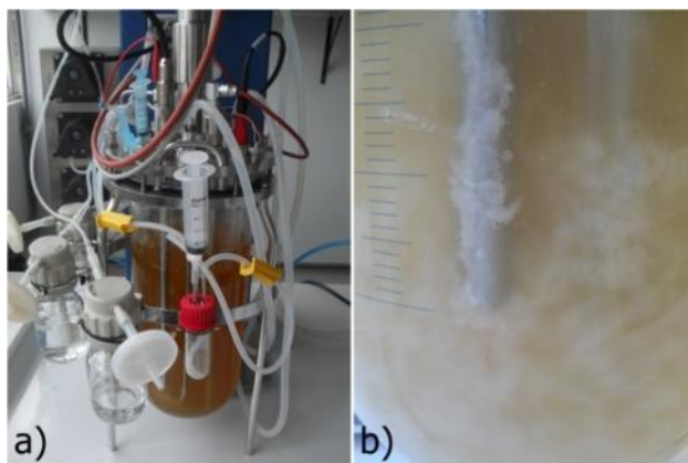
Figura 17 Cultivo do isolado UFSC 209s em biorreator STR modelo Ralf+: a) Vaso do biorreator no início do cultivo; b) Imagem do crescimento do micélio na forma dispersa sob intensa agitação por pás tipo turbina
