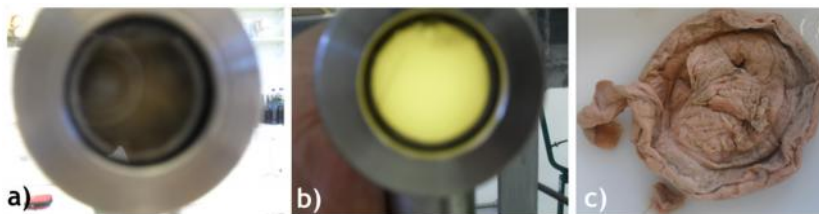
Figura 14 Visor circular na entrada do downcomer do cultivo do isolado UFSC 209s em biorreator Airlift : a) Início do cultivo; b) final; c) Aspecto do tufo de biomassa formado na base do distribuidor de ar removido após esterilização
