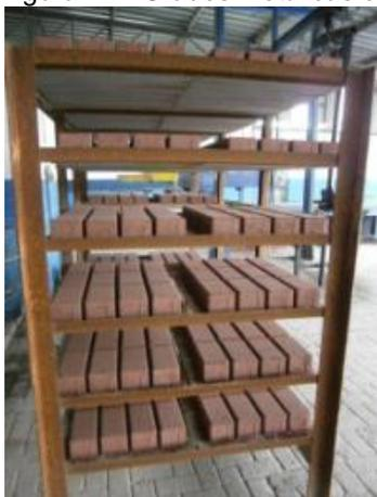
Entende-se por cura os procedimentos tomados para propiciar condições adequadas de temperatura e umidade para o desenvolvimento da resistência mecânica das peças, evitando a evaporação precoce da água necessária à correta hidratação do cimento.
