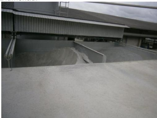
Na Figura 25 é possível observar a parte inferior dos silos dos agregados, observam-se também as esteiras rolantes que levam os agregados até os misturadores, pois os silos abastecem dois misturados.
