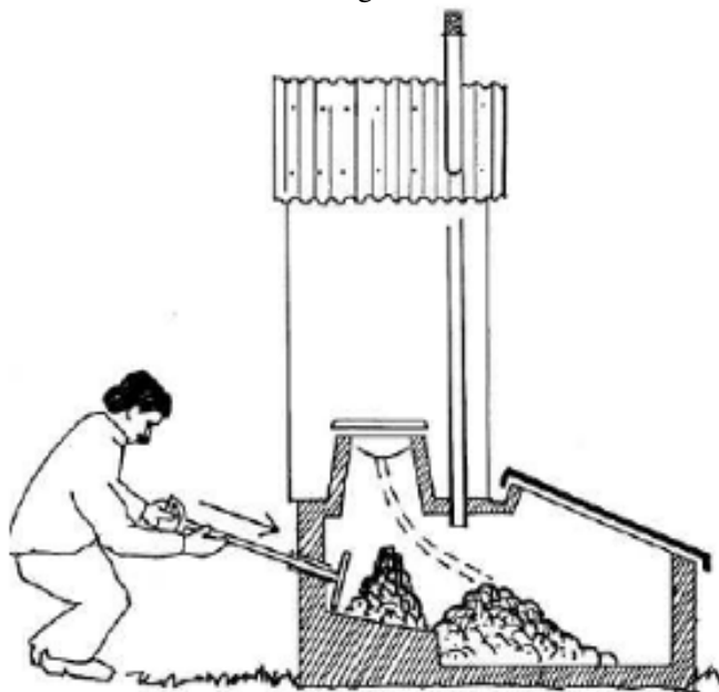
Figura 17: Modelo de câmara única. Detalhe da pilha de fezes frescas que é regularmente transferida para a parte traseira da câmara de secagem.
