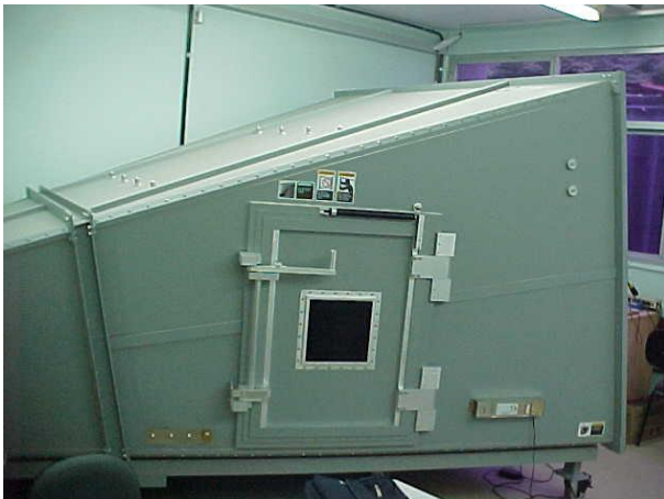
Figura 1.9 - Célula GTEM - instrumento para medição de campo distante
