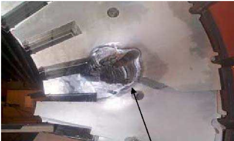
Figure 1.3 – Court-circuit entre tôles d'un stator de turboalternateur [62]
