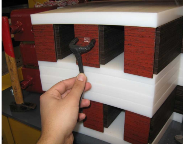
Figure 1.10 – Capteur El Cid devant un paquet de tôles avec défaut (maquette du LSEE 1 )
