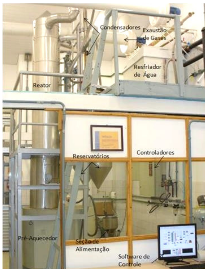
Figura 10. Vista da unidade de craqueamento térmico contínuo.
