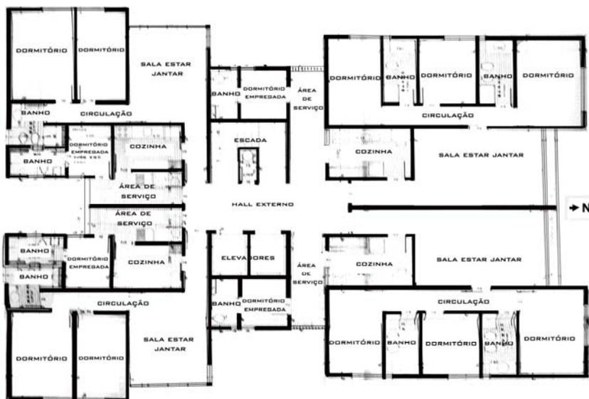
Figura 4.18. Planta baixa do pavimento tipo – edifício Gemini I
