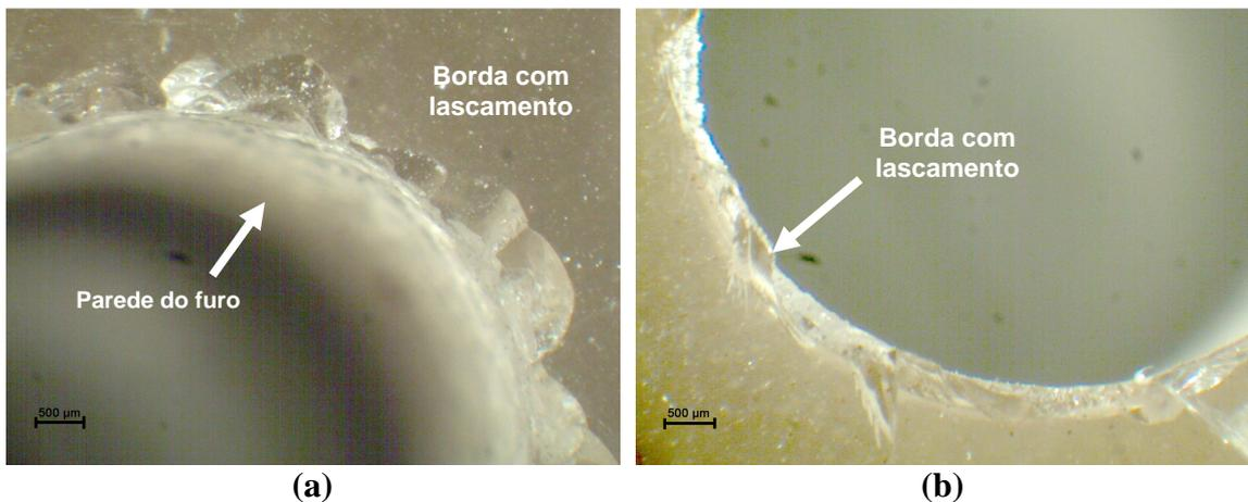
Figura 68 – Resina epóxi com 0% de carga de pó de ferro,  $v_c$  50 m/min.
