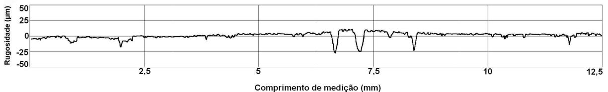
Figura 53 – Perfil de rugosidade da superfície da parede do furo, após ensaio de furação, da resina epóxi com 0% de carga metálica e  $v_c$  de 50 m/min.
