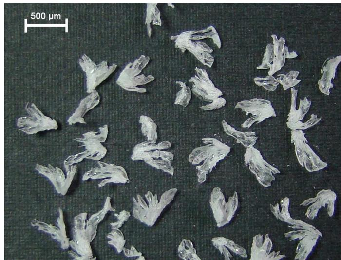
Figura 54 – Cavaco da resina sem carga e  $v_c$  de 50 m/min.
