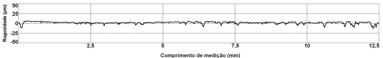
Figura 85 – Perfil de rugosidade da superfície da parede do furo, após ensaio de furação, da resina epóxi com 30% de carga metálica e  $v_c$  de 50 m/min.
