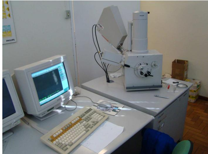
Figura 28 – Microscópio eletrônico de varredura (MEV) - UFSC
