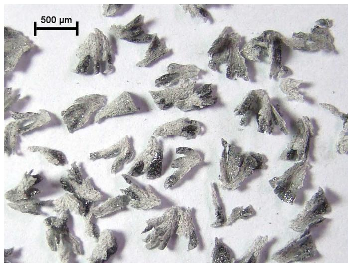
Figura 72 – Cavaco da resina com 10% de carga e  $v_c$  de 50 m/min.
