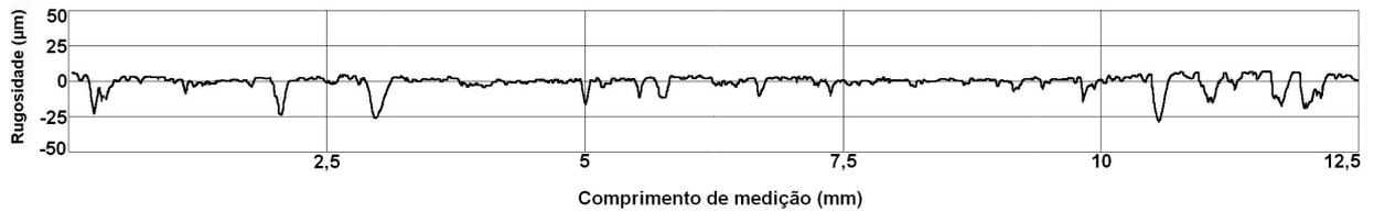
Figura 79 – Perfil de rugosidade da superfície da parede do furo, após ensaio de furação, da resina epóxi com 10% de carga metálica e  $v_c$  de 100 m/min.
