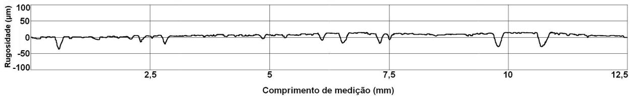
Figura 59 – Perfil de rugosidade da superfície da parede do furo, após ensaio de furação, da resina epóxi com 0% de carga metálica e  $v_c$  de 100 m/min.
