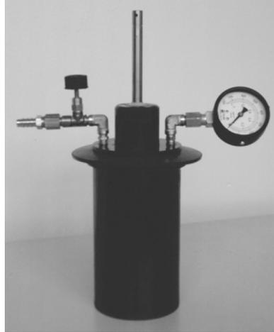
Figura 35 – Misturador especial a vácuo com manômetro.
