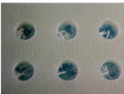
Figura 21 – Efeito de delaminação na furação de material compósito com carga de fibras (ARAÚJO; ABRÃO; FARIA, 2005).
