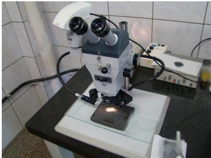
Figura 26 – Estereoscópio com câmera CCD.
