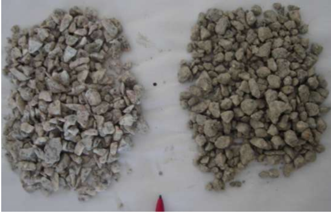
Figura 8.7 – Britas 4,75 / 12,5 utilizadas pela: a) central FL e b) central SJ.
