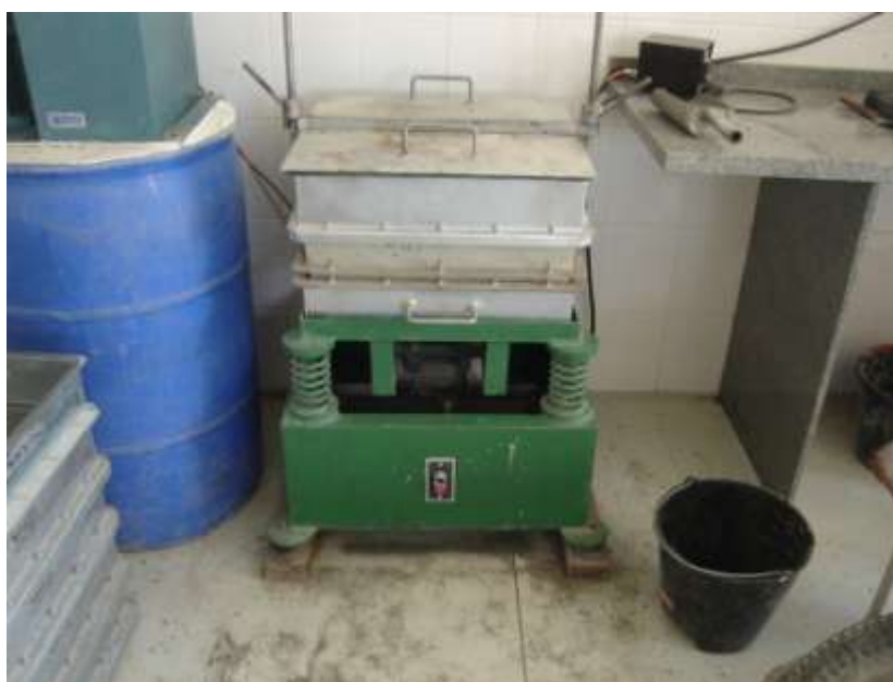
Figura 4.4 – Peneiramento mecânico da areia de britagem.
