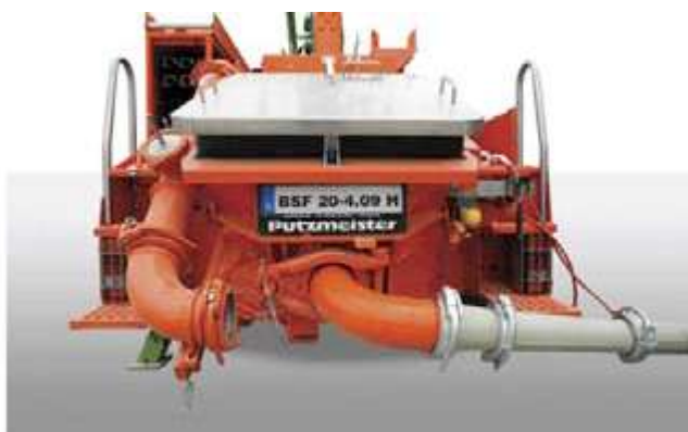
Figura 3.2 – Redução da seção da tubulação logo após a saída da bomba de concreto (Putzmeister, 2004).
