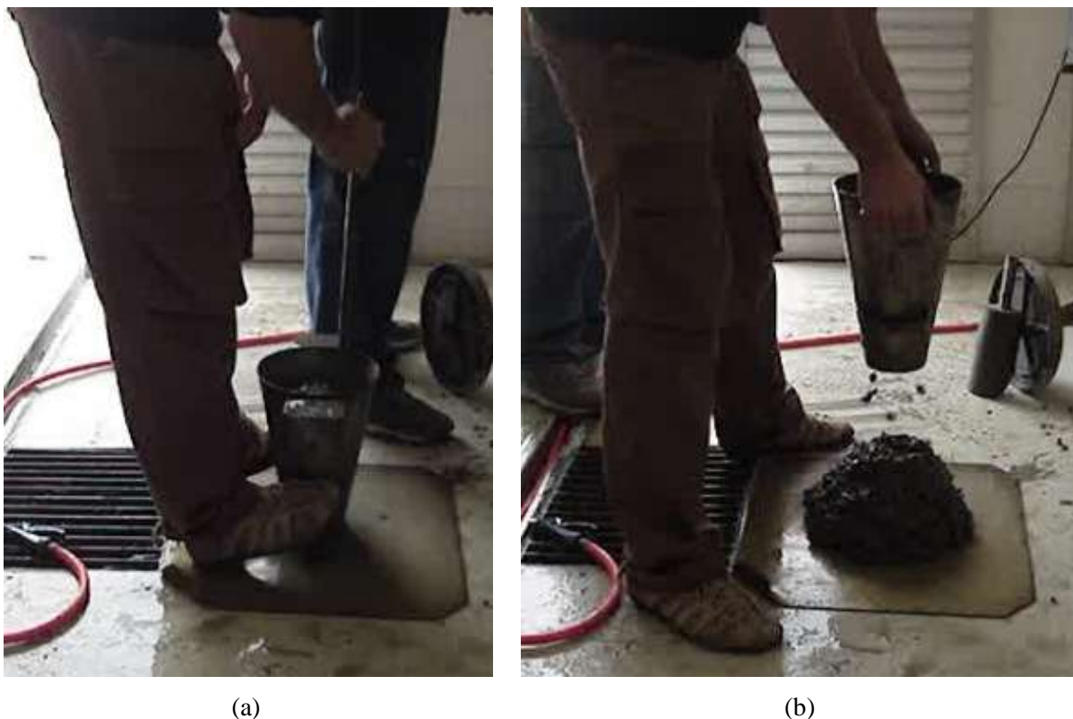
Figura 8.2 – Proposta inicial do ensaio de cone invertido: (a) preenchimento do cone sobre chapa metálica e (b) levantamento do cone.
