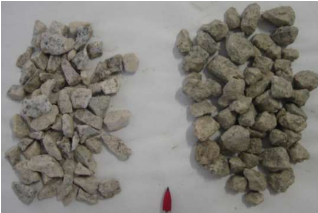
Figura 8.8 – Britas 9,5 / 25,0 utilizadas pela: a) central FL e b) central SJ.
