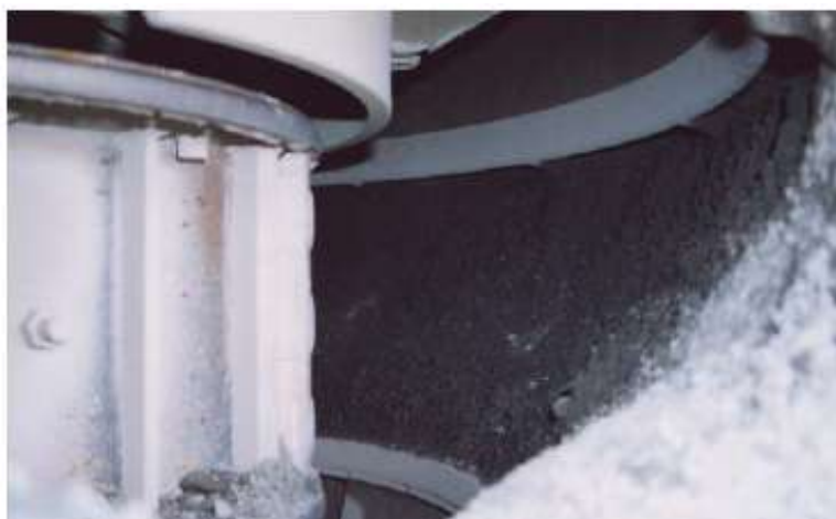
Figura 2.16 – Rotor, à esquerda, e câmara de acúmulo de material onde ocorre a cominuição autógena, à direita (METSO MINERALS, 2005).
