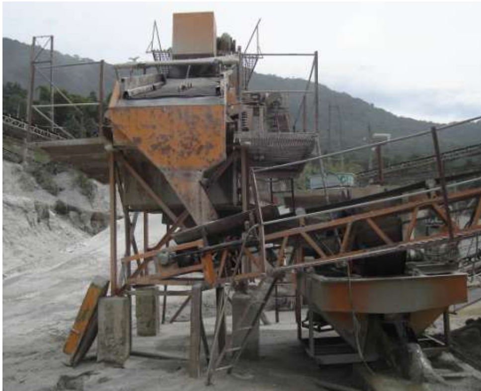
Figura 2.25 – Detalhe do peneirador de granilha, ao lado da roda desaguadora, empregados em pedra da região da grande Florianópolis.
