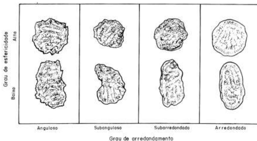
Figura 2.6 – Tabela padrão para avaliação do grau de esfericidade e arredondamento de agregados (NBR 7389:1992).
