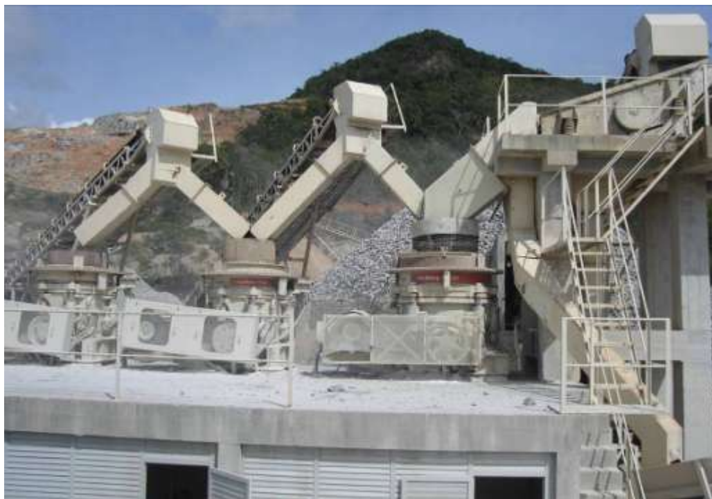
Figura 2.9 – Da direita para a esquerda: Pré-peneiramento, britador secundário, britador terciário e britador quaternário.
