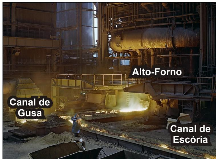
Figura 1.7. Fotografia de um alto-forno e seu canal de separação.
