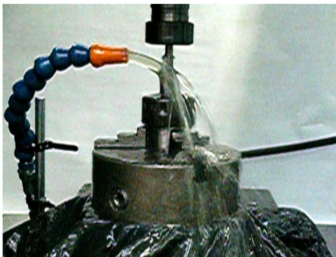
Figura 3.8 – Aplicação de fluido de corte
