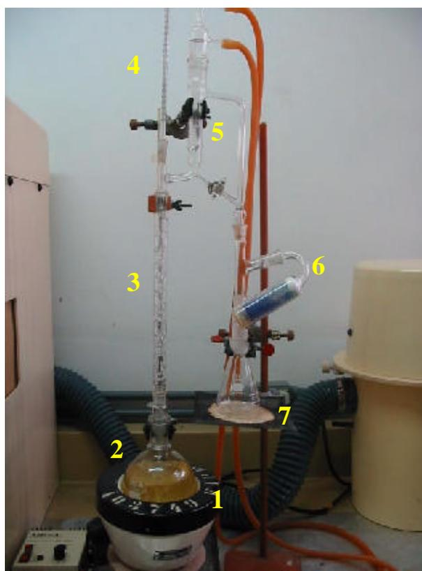
**Figura 9.** Sistema montado para secagem de solvente, composto de: manta de aquecimento (1); balão de fundo redondo (2); coluna de fracionamento (3); termômetro (4); sistema de condensador com dedo frio (5); tubo com silica gel (6); Frasco coletor (7).
