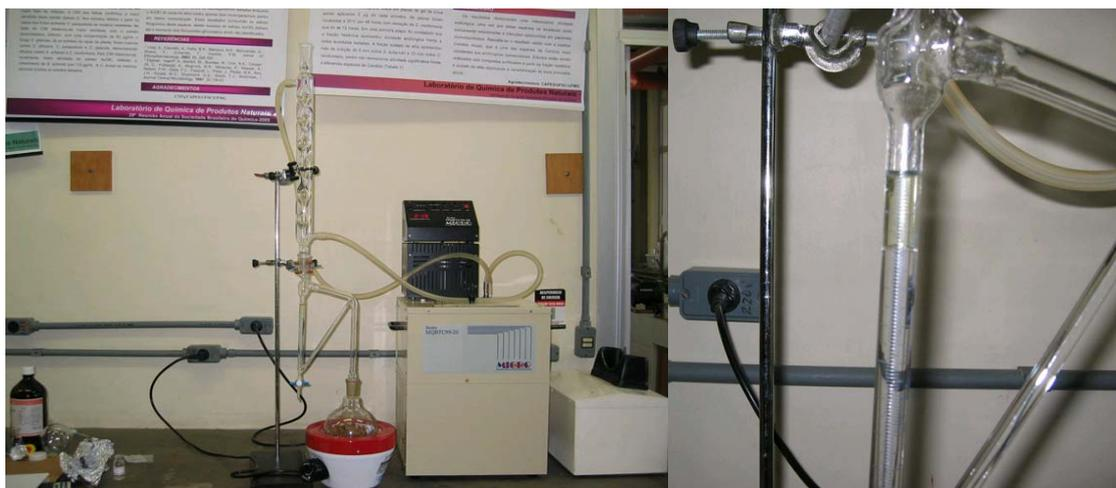
Figura 2 – Equipamento Clevenger adaptado utilizado para extração do óleo essencial
