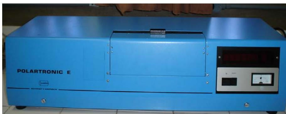
Figura 3 – Polarímetro utilizado na determinação da rotação óptica
