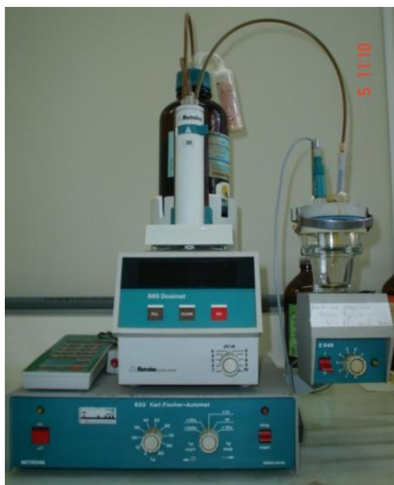
Figura 13 – Fotografia do titulador automático de Karl Fischer.
