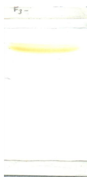
Figura 10 – Placa de sílica eluída com hexano/acetato de etila 4:1, após a segunda purificação do composto 1 .
