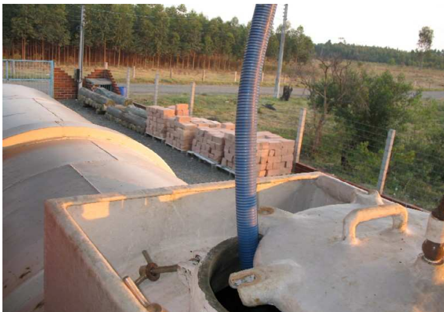
Figura 9. Foto do carregamento do hipoclorito de sódio no caminhão tanque no exterior da fábrica.
