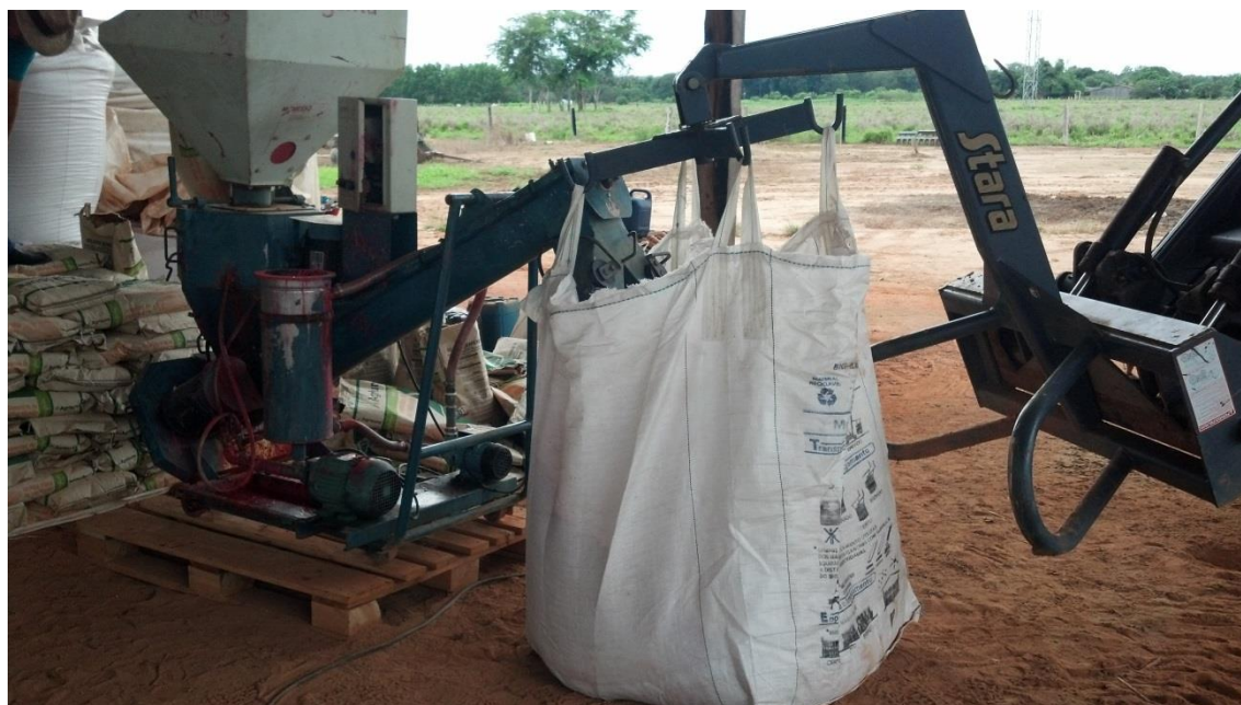
Figura 20. Máquina Grazmec, modelo MTS 60 Spray System para tratamento de sementes. Fonte: Registro fotográfico do autor, 2013.
