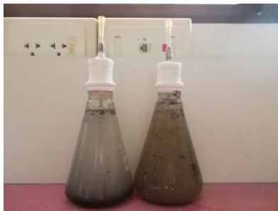
Figura 3.2 – Biorreatores usados para biodegradação de BTX
