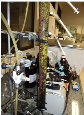
Figura 3.9 – Reator em fluxo contínuo (coluna) usada para biodegradação dos compostos BTX.
