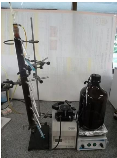
Figura 3.3 – Aparato experimental para determinação da concentração de tolueno e o-xileno em fluxo contínuo.
