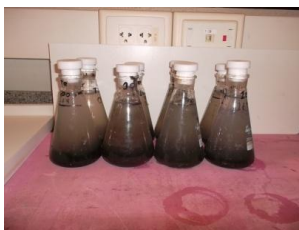
Figura 3.8 - Aparato experimental utilizado para realização das cinéticas de biodegradação dos compostos BTX.
