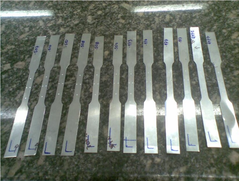
Figura 3.5 – Corpos-de-prova utilizados no ensaio de tração e anisotropia
