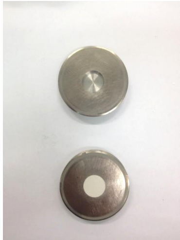
Figura 15 – Porta-amostra do difratômetro; detalhe acima: postra-amostra vazio; detalhe abaixo: porta amostra com o pó de Degussa P25 compactado.
