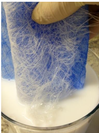
Figura 9 – Detalhe do processo de deposição por imersão.
