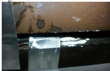
Figura 45 - Posicionamento do transdutor no bloco de aço.
