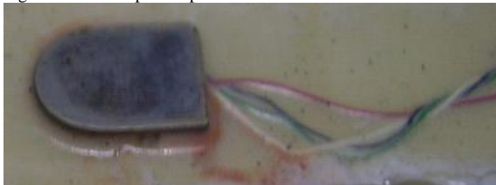
Figura 16 - Protótipo encapsulado com filme de PEEK.
