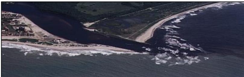
**Figura 7.21: Transposição de sedimentos entre a praia de Barra do Sul e a Praia Grande junto à desembocadura do canal do Linguado, na direção do transporte sedimentar resultante (Foto:SANTA CATARINA/SEPLAN, 1994).**
