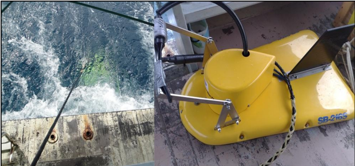
Figura 3.4 - Sistema de perfilagem sub-superficial do fundo Chirp Edgetech 3100-P, utilizado no levantamento geofísico no encaminhamento do futuro emissário submarino na Praia do Campeche (a direita observa-se o fish, e a esquerda se observa o mesmo em funcionamento, towfish, rebocado pela embarcação).
