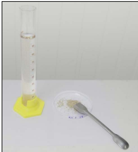
Figura 10: Sistema para determinação do Índice de Inchamento de Foster
