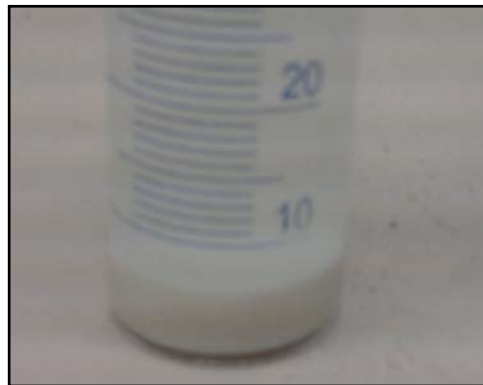
Figura 16: Inchamento da bentonita Coral em água
