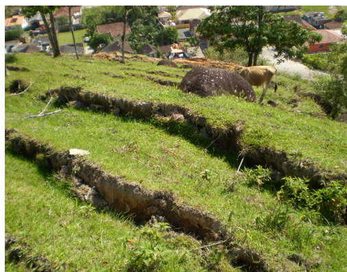
Figura 6.37 – Fendas de abatimento paralelas, no solo, evidenciando o movimento do material da encosta, no Morro da Cana, na área urbana de Antônio Carlos. Foto: Prefeitura Municipal de Antônio Carlos, 09 de dez. 2008.
