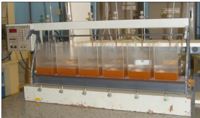
Figura 7 – Aparelho Jarreste utilizado nos ensaios para determinação do pH ótimo de precipitação de metais.
