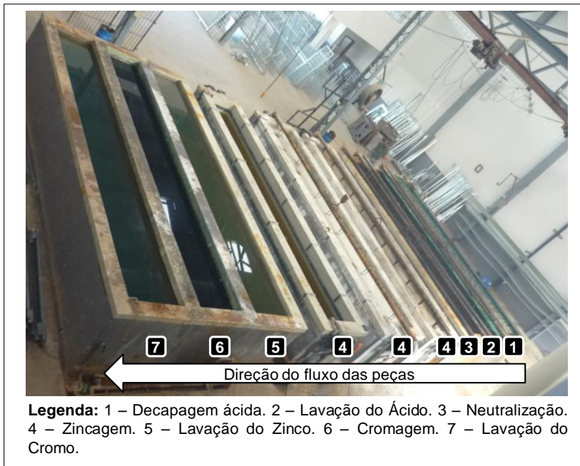
Figura 13 – Tanques do processo galvânico da empresa parceira.
