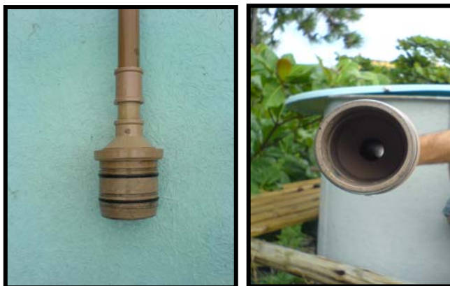
Figura 21 – Foto do tampão do tubo central do FLRb
