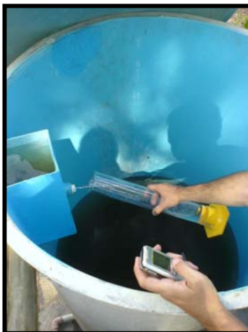
Figura 26 - Foto da aferição volumétrica da vazão
