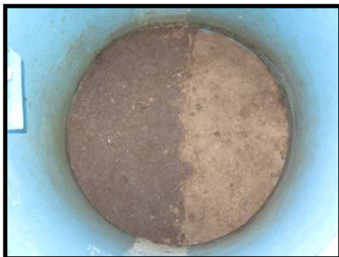
Figura 41 - Foto do filtro FLC após raspagem da camada biológica
