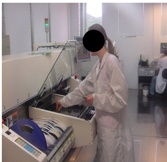
Figura 9 – Execução da montagem automática de placas eletrônicas
