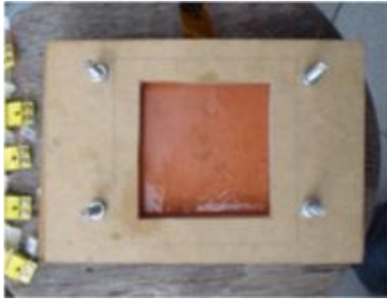
(c) Câmara com fluido refrigerante 141b
