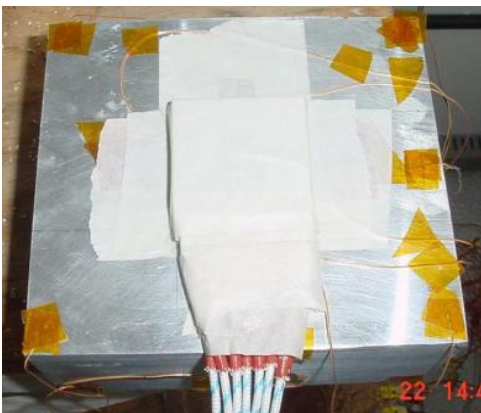
(c) Isolamento resistência
