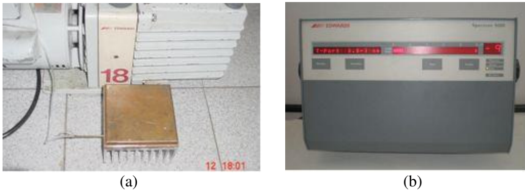
Figura 4.7 Processo de evacuação e detector de vazamento.
