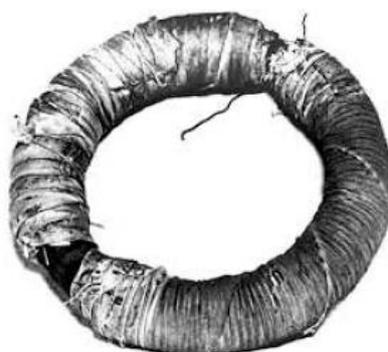
Figura 2.1 – Foto do transformador original de Faraday (COLTMAN [1]).
