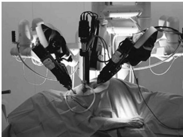
*Figura 3 - Robô cirúrgico da Vinci com três braços articulados em operação (Menzel e D'aluisio, 2001).*
