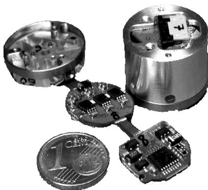
*Figura 5 - Sensor de força produzido para a mão robótica DLR II (DLR, 2007).*
