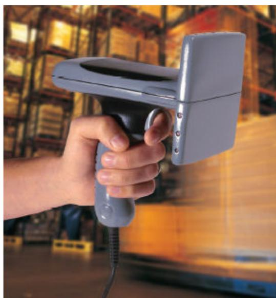
Figura 4.2 – Leitor de RFID móvel
