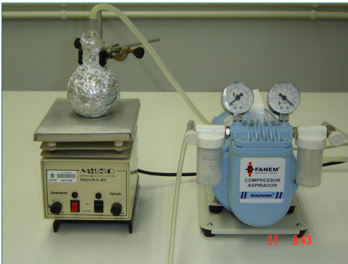
Figura 7 Sistema utilizado para as reações de interesterificação química e enzimática
