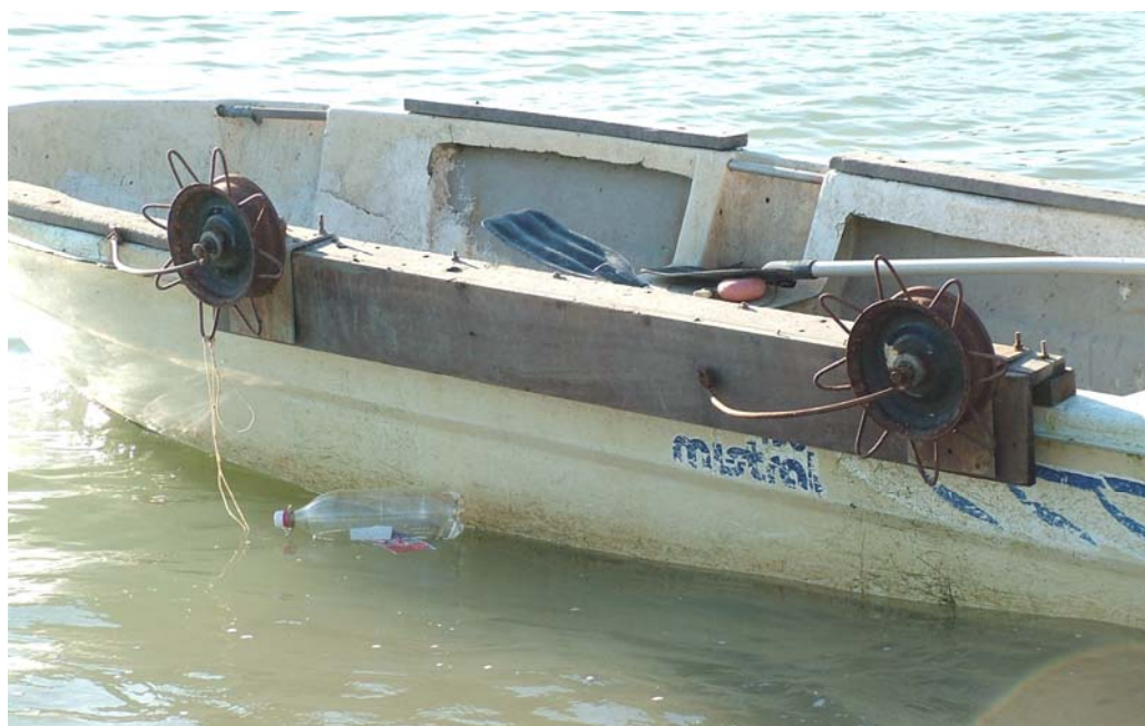
Figura 5.11 – Imagem do protótipo fixado em uma embarcação com os sistemas de fixação e trilhamento.
