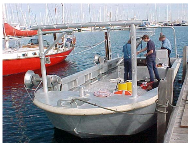
Figura 4.11 – Embarcação neozelandesa com sistemas de rodas para guiar cabo do espinhel apoiados em um bordo da embarcação
