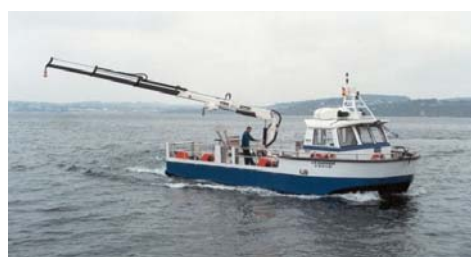
Figura 2.45 - Embarcação de grande porte, cabine proa, com braço hidráulico telescópico central - (McBridedesign, 2004).
