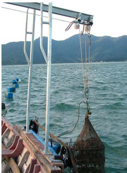
Figura 6.18 - Sistema de polias usando um cadernal ou moitão erguendo uma lanterna.
