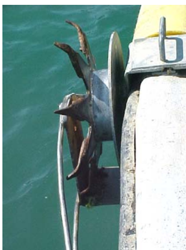
Figura 2.37 - Roda estrela - serve como guia para long line e permite passagem de bóias e cabos de suporte das estruturas de cultivo - CTTMAR - Univali.
