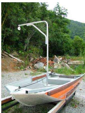
Figura 2.15 - Embarcação de 3,5m com capacidade de 70 kg de carga.
