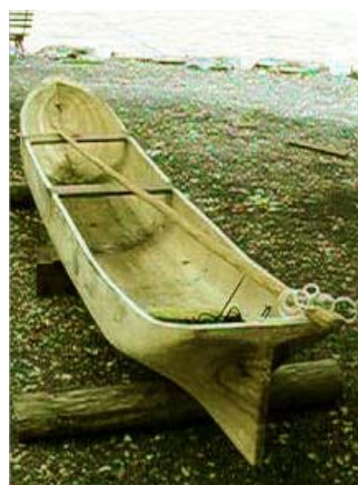
Figura 2.20 - Canoa esculpida em tronco de madeira usada para manejo em sistemas suspensos, instável e com baixa capacidade de carga
