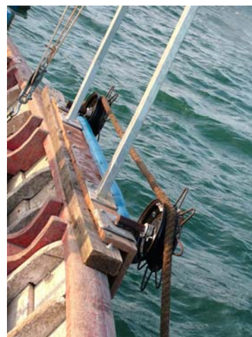
Figura 6.10 – Sistema de fixação e trilhamento de espinhel na embarcação A.
