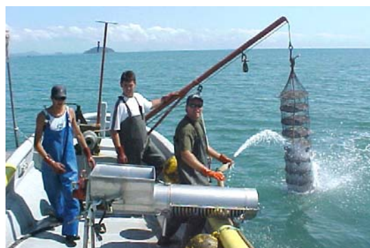
Figura 2.36 - Sistema de deslocamento das lanternas com guincho de acionamento hidráulico - CTTMAR - Univali.
