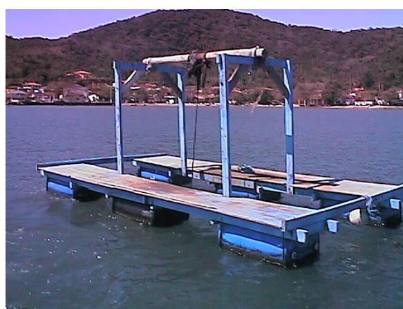
Figura 2.26 – Balsa de manejo de poitas adaptada por produtores incluindo uma área plana de movimentação – GEPP (2003).
