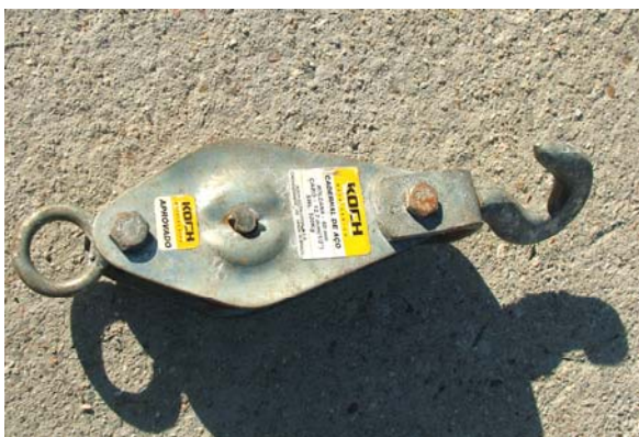
Figura 5.15 – Moitão de 450 kg de capacidade de carga.
