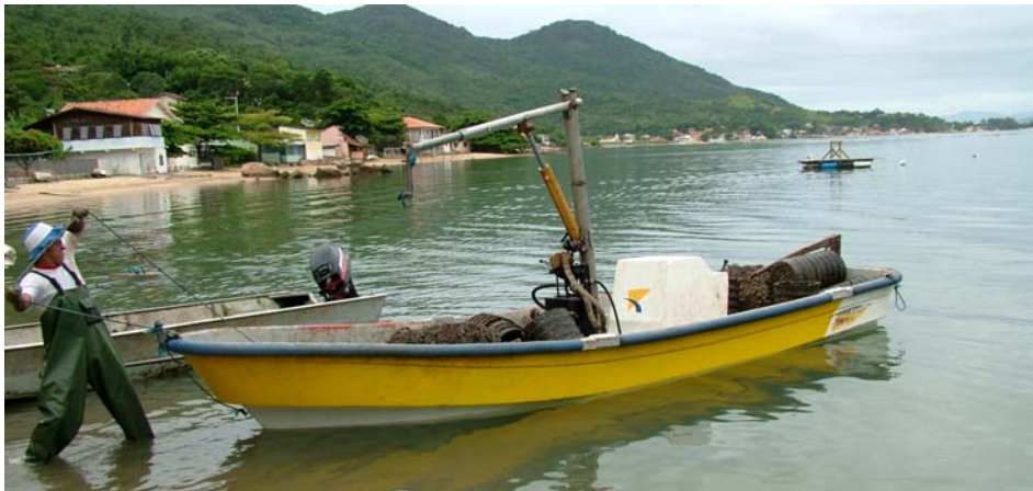
Figura 2.39 – Embarcação em fibra de vidro com braço hidráulico central.
