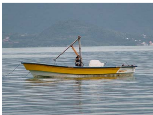
Figura 2.21 – Embarcação de fibra adaptada com sistema elevatório hidráulico.
