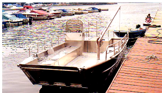
Figura 2.49 - Embarcação de alumínio com guincho manual lateral - Alucraftboats (2003).
