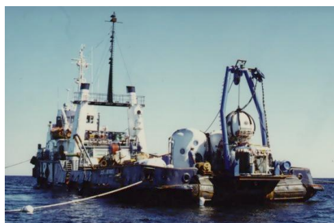
Figura 2.43 - Guindastes de braço duplo para grandes cargas instalado na popa - (Mcbridedesign, 2004).
