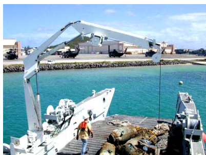
Figura 2.50 - Braço hidráulico c/ cabo para remoção de grandes cargas.
