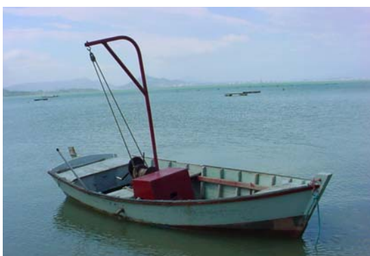
Figura 2.31 – Embarcação tipo baleeira adaptada com guincho mecânico acoplado ao motor.
