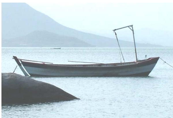
Figura 2.33 – Embarcação adaptada com guincho de mastro e lança Sambaqui – Florianópolis – SC
