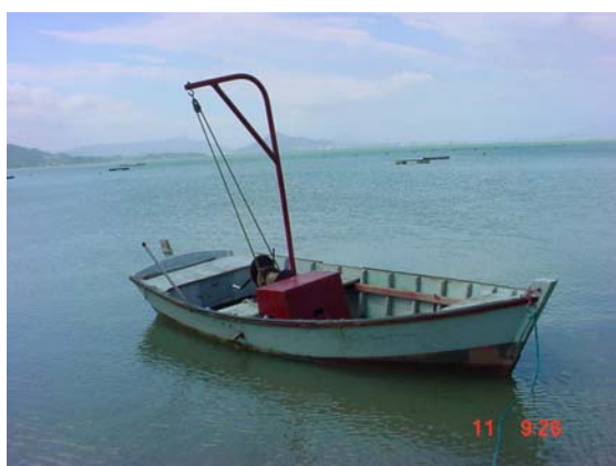
Figura 2.17 - Bote com sistema de deslocamento adaptado ao motor de propulsão.
