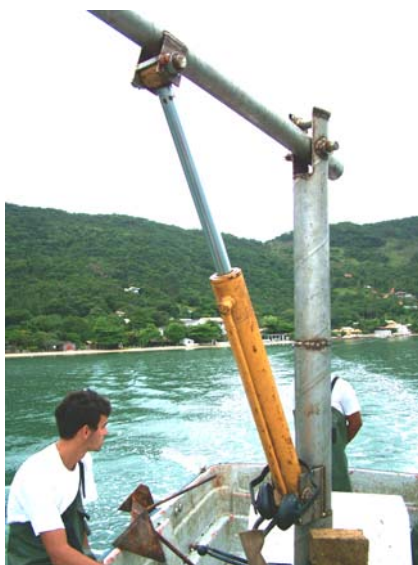
Figura 2.40 – Sistema hidráulico em curso total de elevação.
