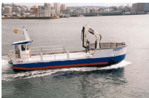
Figura 2.42 –Embarcações de grande porte, cabine popa, para manejo e transporte de grandes cultivos na- (McBridedesign, 2004)
