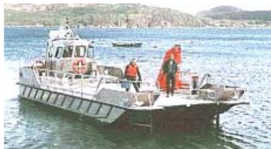
Figura 2.47 - Embarcação de alumínio com braço hidráulico lateral; - Alnmaritec (2003).
