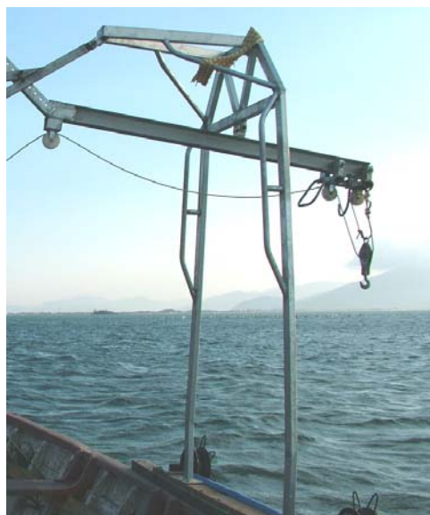
Figura 6.19 - Sistema de polias usando um cadernal ou moitão.
