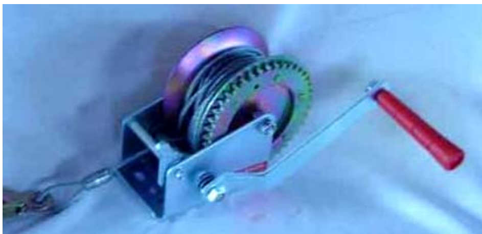
Figura 4.57 – Guincho usado para içamento
