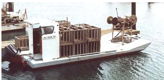
Figura 2.46 - Embarcação de manejo de cestos de cultivo de lagostas com guincho elétrico utilizando roldanas e polias - Wstportwa (2003).
