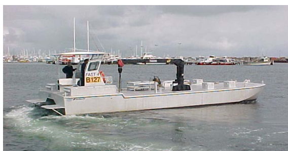
Figura 2.44 - Embarcação de alumínio para com guincho central - Alucraftboats (2004).
