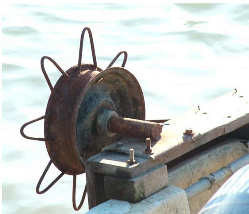
Figura 5.12 – Imagem do protótipo fixado em uma embarcação com os sistemas de fixação e trilhamento.
