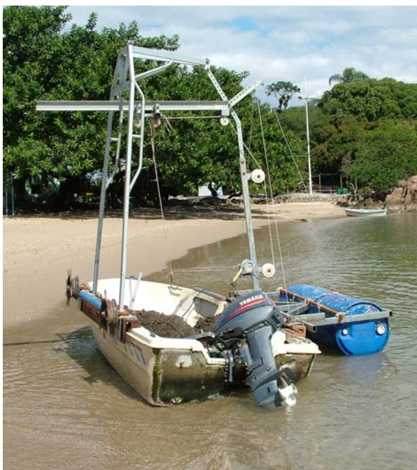
Figura 6.13 – Vistas traseira da embarcação B com o sistema de estabilização / flutuação.
