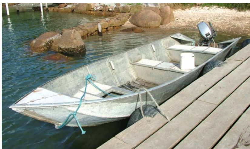
Figura 2.52 - Barco de alumínio (duralumínio) rebitado utilizado comumente no manejo.
