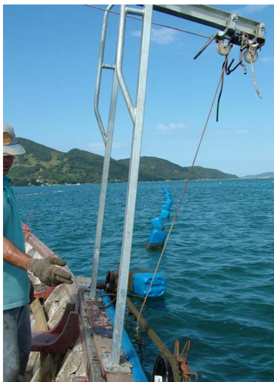
Figura 6.21 – Sistema de polias usando um cadernal ou moitão.
