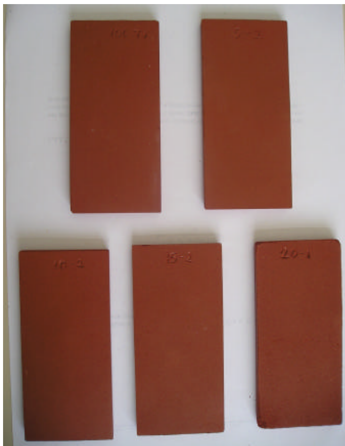
Figura 7 - Corpos de prova das formulações da argila AT da queima à 1050°C.
