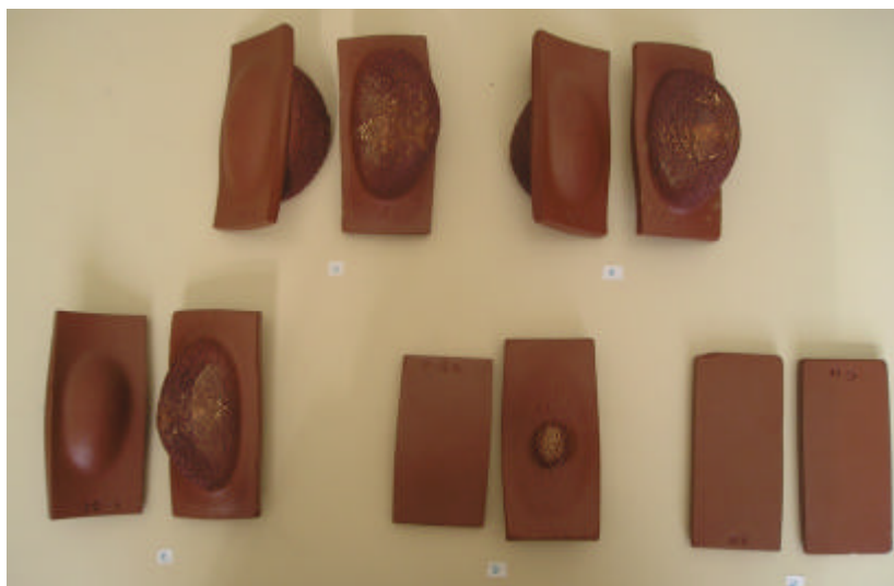
Figura 19 - Corpos de prova das formulações da argila AT queimados à 1150°C.
