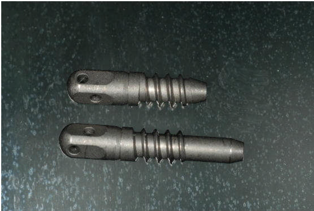
Figura 1- Macroestrutura dos mini-implantes ortodônticos de 6mm e de 10 mm de comprimento (Bicon Implants. Boston, MA). Observar, no módulo superior, a fenda circular para instalação de aparelhos ortodônticos.
