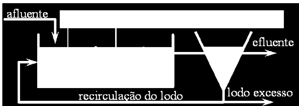
Figura 3.1. Princípio dos sistemas de lodo ativado
