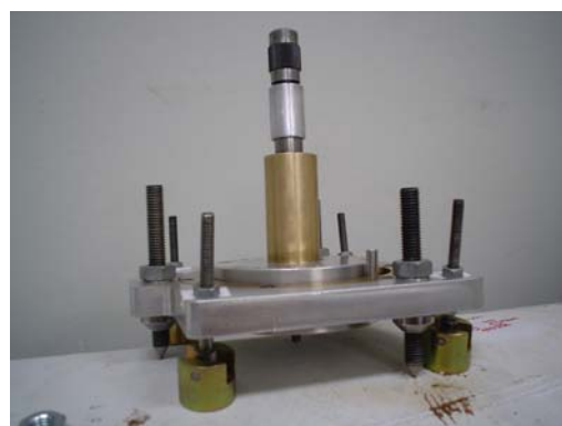
Figura E.4 Módulo de indentação sobre a superfície de medição
