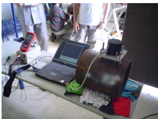
Figura E.1 Módulo de Medição de Tensões Residuais Labmetro / UFSC - Roseta Óptica e detalhes de fixação.
