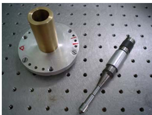
Figura E.3 Módulo de indentação – detalhes do indentador
