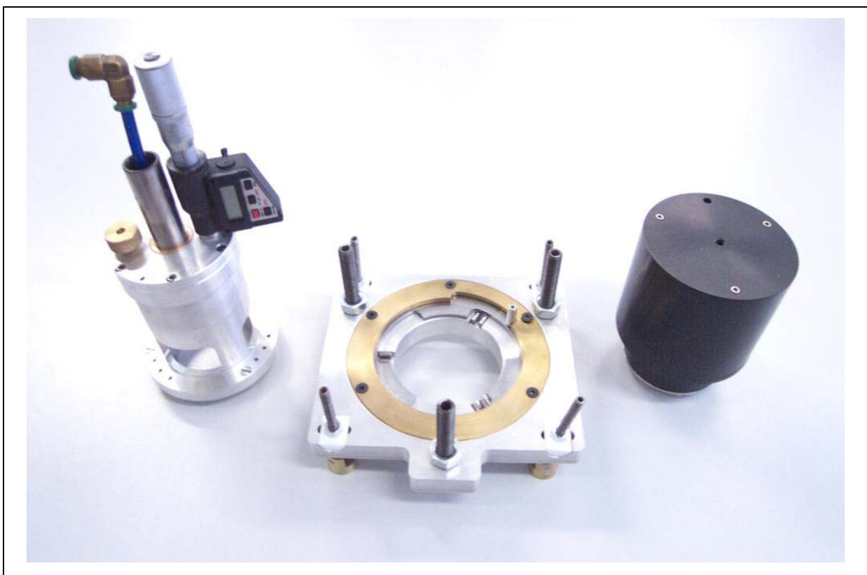
Figura 5.2 MTRES Modular ou M2TRES - Dispositivo para medição de tensões mecânicas e tensões residuais por holografia eletrônica.
