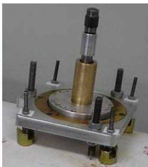
(b) sistema de indentação sobre a base universal do medidor de tensões residuais.
