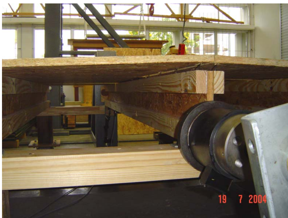
Figura 60 – Arrancamento dos pregos lisos, observado ao término do ensaio de flexão.
