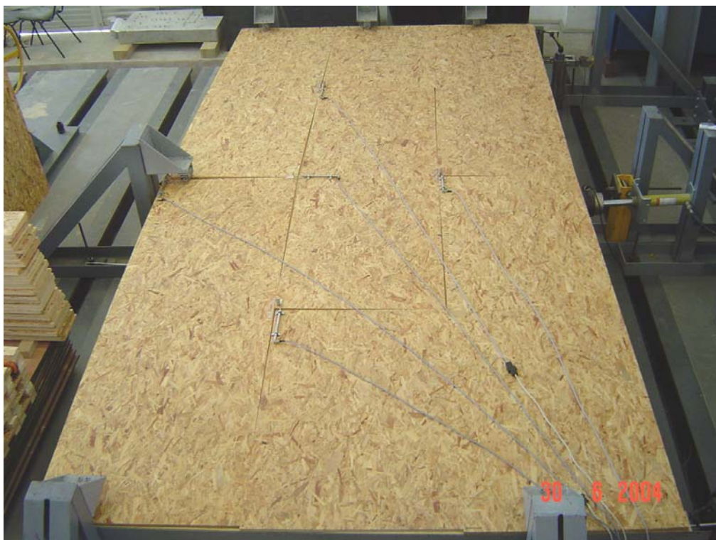
Figura 62 – Deslocamentos das chapas de fechamento observado ao término do ensaio de flexão.
