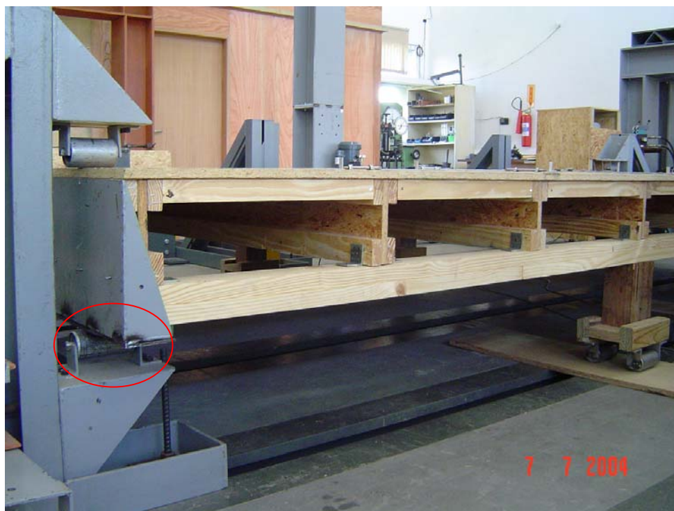
Figura 44 – Dispositivos rotativos da estrutura de contenção.
