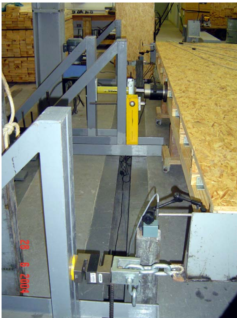
Figura 45 – Disposição das células de carga nos diafragmas horizontais de piso.
