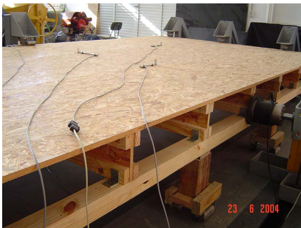
Figura 47 – Disposição dos transdutores de deslocamento nos protótipos.
