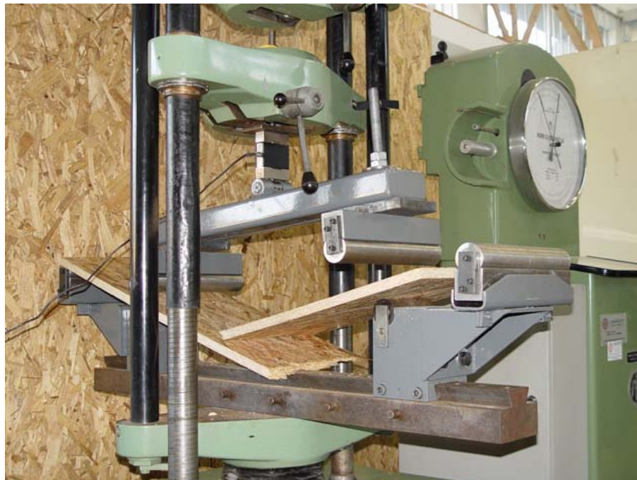
Figura 50 – Ruptura verificada no ensaio de flexão vertical.
