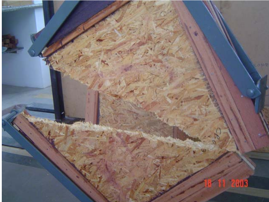
Figura 52 – Ruptura dos corpos-de-prova de cisalhamento ao longo da espessura.
