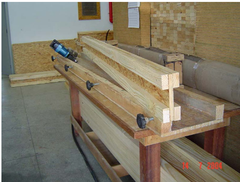
Figura 29 – Confeção das vigas-I empregadas como elementos de ossatura.
