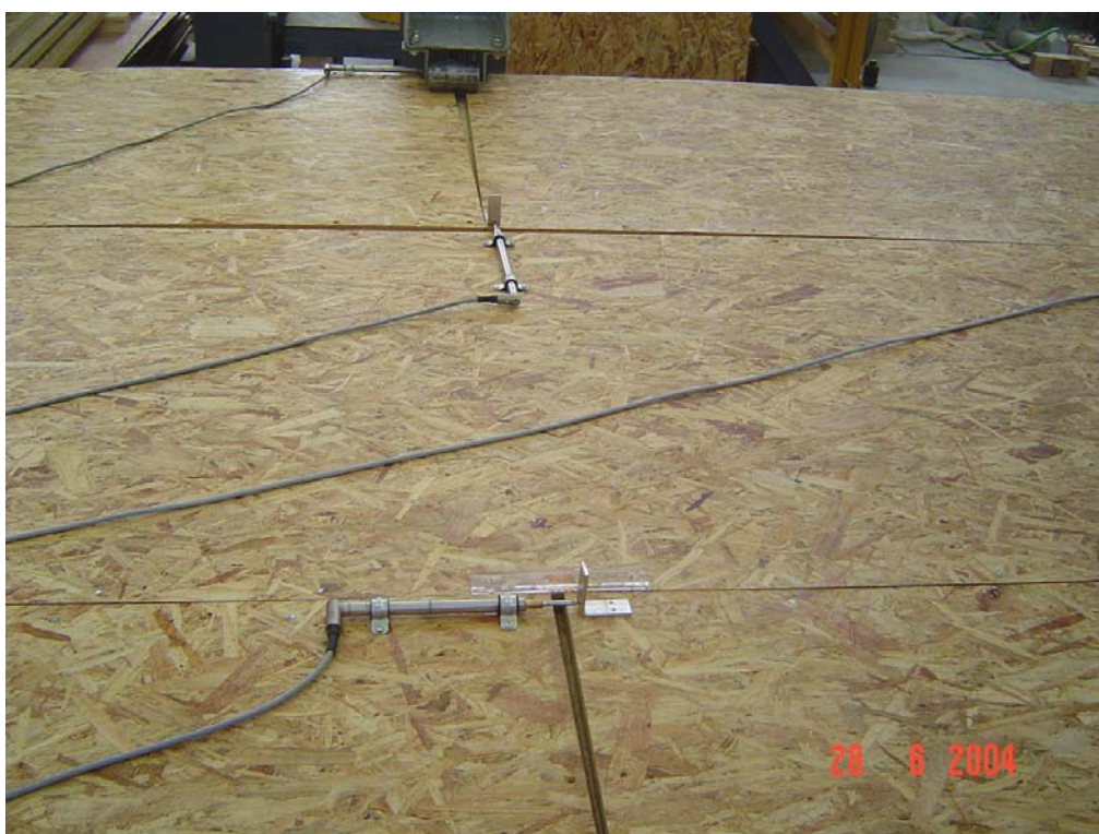
Figura 61 – Deslocamentos das chapas de fechamento observado ao término do ensaio de flexão.
