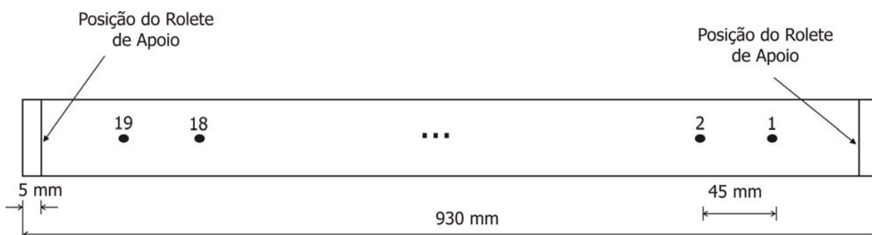
Figura 4.1 – Esquema dos pontos de medição na viga
