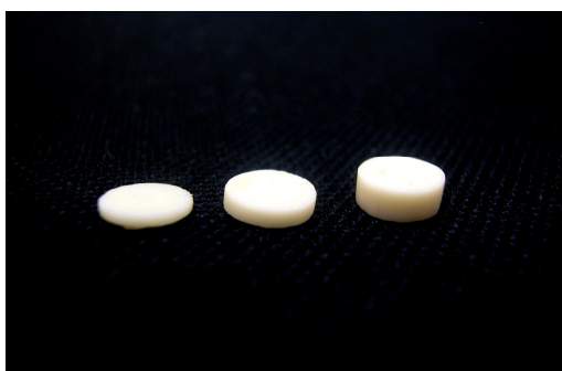
Figura 3: discos de cerâmica de infra-estrutura utilizados como obstáculos.
