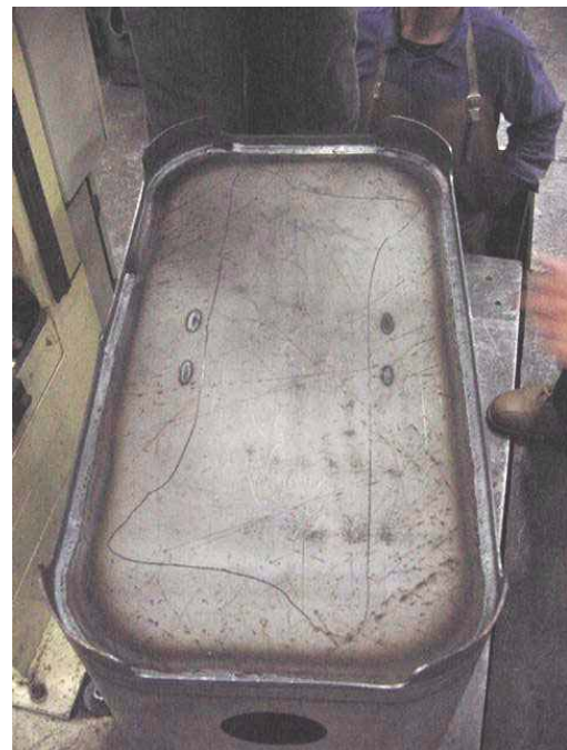
Figura 4.38 - Fundo do transformador soldado com o auxílio do "Tartilope V2".
