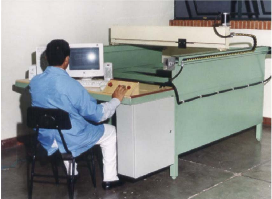
Figura 2.28 – Mesa de Coordenadas XY Desenvolvida pelo LAPROSOLDA.
