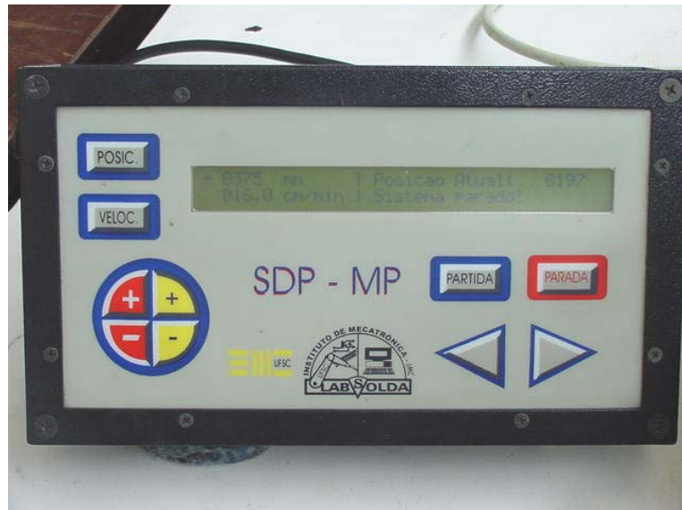
Figura 2.20 – Painel de controle do Sistema de deslocamento “Tartílope V1” (mesmo do “SDP-MP”).
