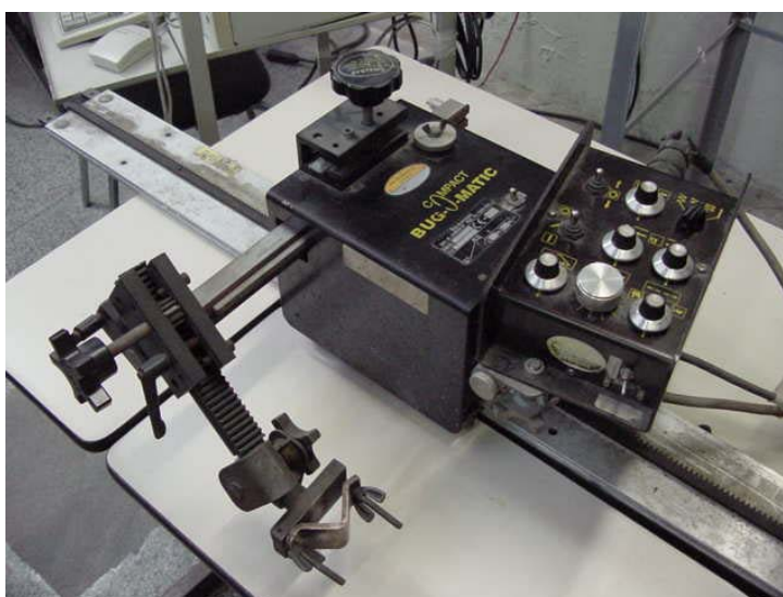
Figura 2.6 - Sistema de deslocamento importado capaz de realizar o movimento de tecimento.
