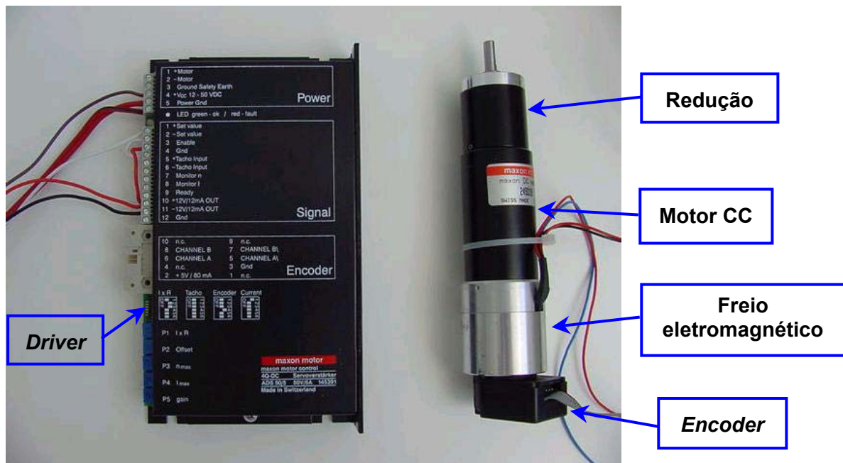
Figura 3.4 - Motor e driver do fabricante MAXON MOTOR, utilizados no sistema de soldagem TIG orbital.
