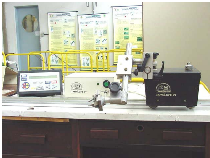
Figura 2.18 – Sistema de deslocamento de pistola “Tartílope-V1”.
