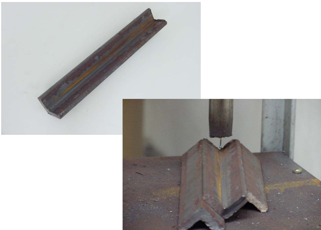
Figura 3.1 - Fotos do corpo de prova utilizado nos ensaios de teste de funcionalidade do sistema de seguimento de junta.
