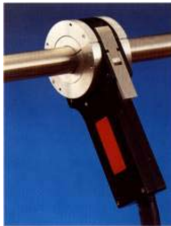
Figura 2.8 – Exemplo de um cabeçote orbital de câmara fechada.
