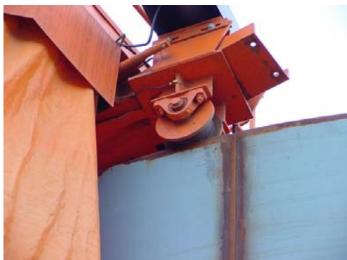
2.13a - Detalhe de uma das rodas que fazem o deslocamento do equipamento.
