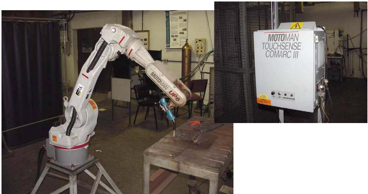
Figura 2.7 - Robô de seis eixos e o acessório “Torch Sense”.
