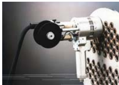
Figura 2.10 – Exemplo de um cabeçote orbital de superfície.
