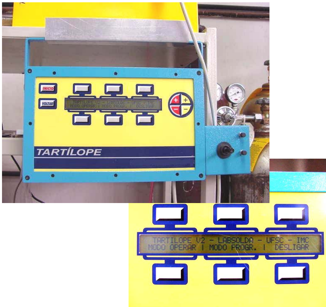
Figura 4.8 - Foto do teclado de comando mostrando o menu inicial do “Tartilope V2”.
