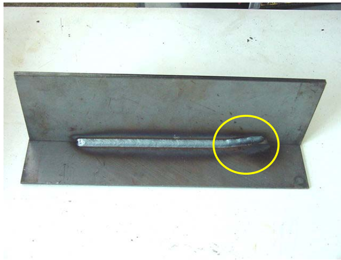
Figura 4.39 - Corpo de prova realizado para verificar a eficácia do sistema de seguimento de junta implementado.
