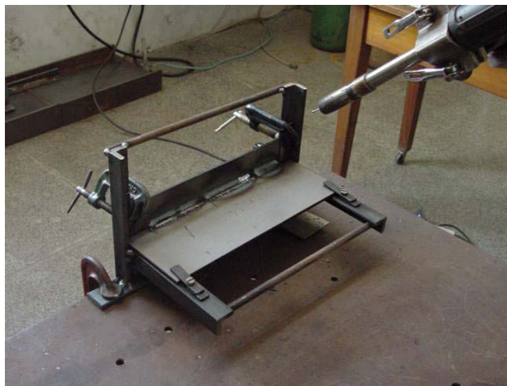
Figura 4.31 - Ensaios para a determinação de viabilidade da realização da solda.
