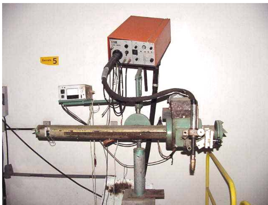
2.14 – Primeiro dispositivo de condução de pistola de soldagem produzido pelo LABSOLDA.
