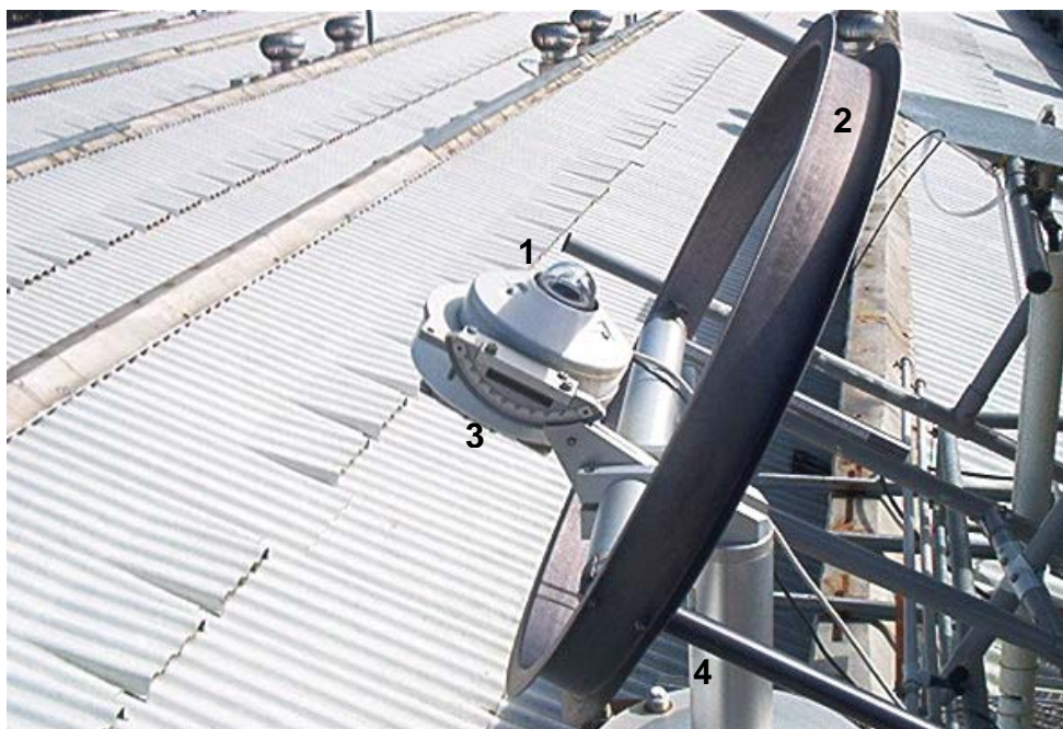
Figura 6 – Transdutor para a medição da radiação difusa – legenda: piranômetro (transdutor de radiação global) (1), dispositivo anel sombreador (2), ajuste do ângulo de inclinação \beta do piranômetro no centro do anel sombreador (3), ajuste da posição do anel no eixo geográfico da terra (4).
