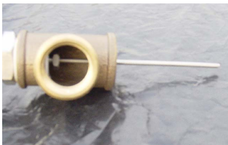
Figura 7 – Transdutor de temperatura Pt100, rosqueado em uma conexão de tubulação do tipo T de 3/4” da norma NPT utilizado para medir as temperaturas na entrada e saída do coletor assim como a temperatura da água ao lado do medidor de vazão volumétrico
