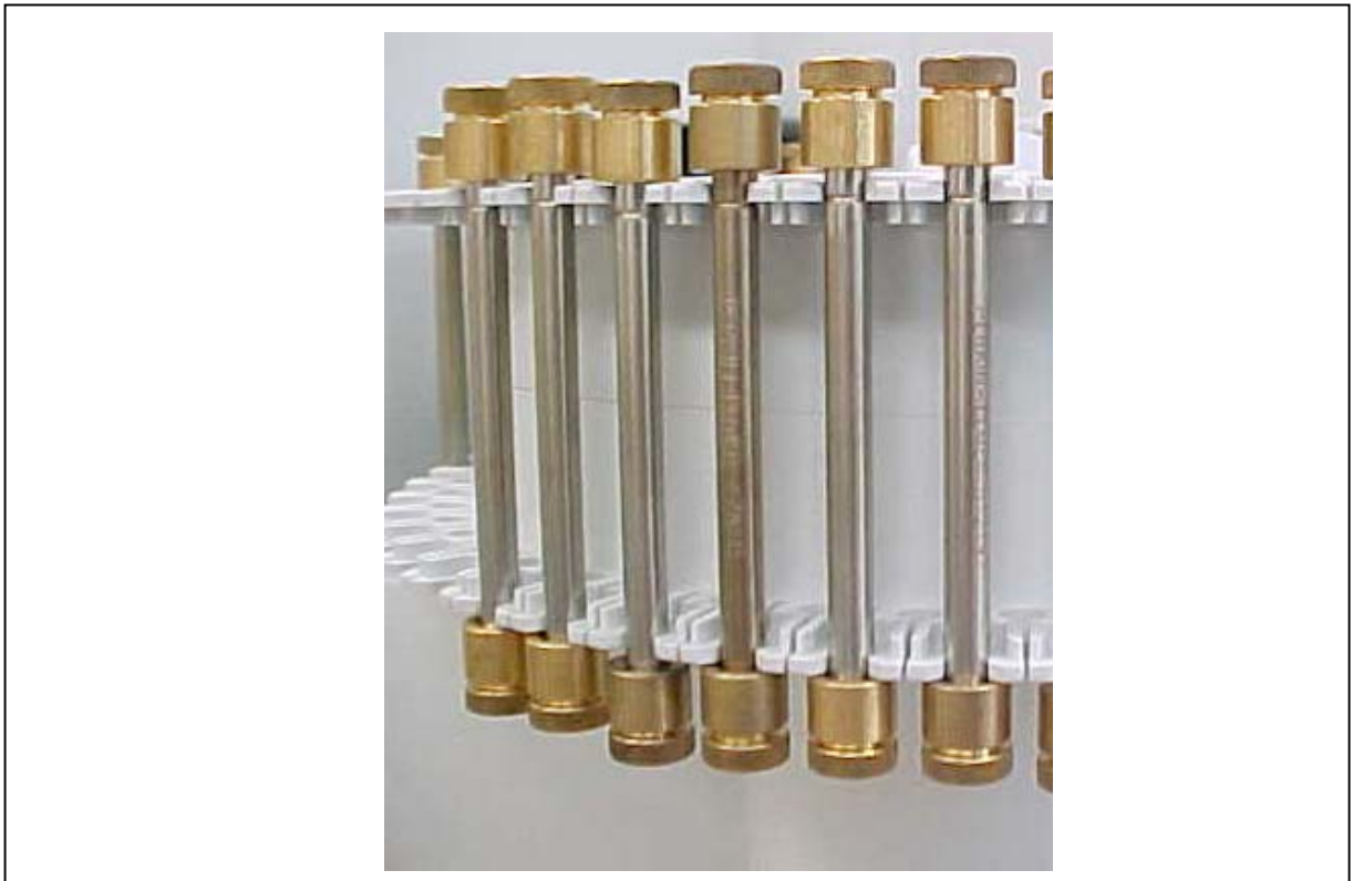
Figura 9 – Tubos amostradores da PerkinElmer utilizados
