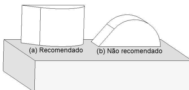
Figura 9 – Exemplos de disposições de uma peça na plataforma.
