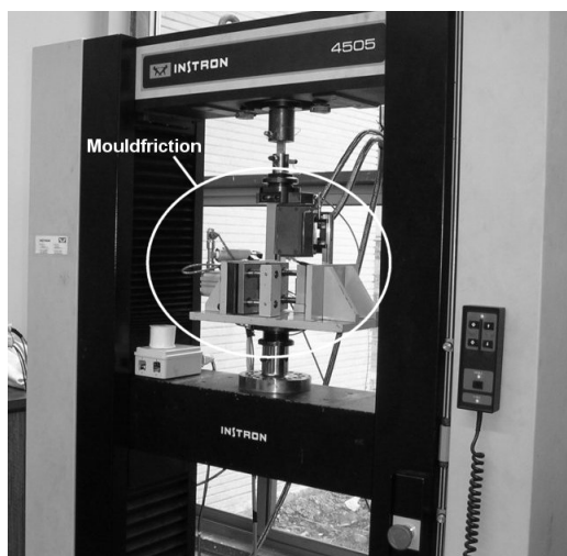
Figura 99 – Equipamento Mouldfriction acoplado sobre uma máquina universal de ensaios mecânicos.
