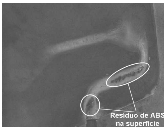
Figura 71 – Filme de Ni-P retirado no início do processo de injeção.
