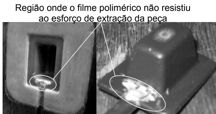
Figura 83 – Região onde o filme polimérico não resistiu ao esforço de extração da peça.
