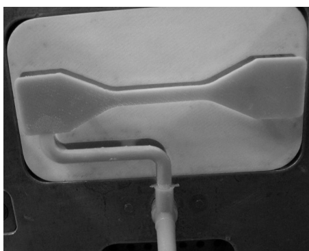
Figura 86 – Corpo de prova em PA injetado no inserto de PC.
