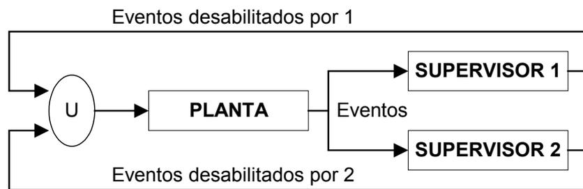
Figura 3.7 - Esquema de controle modular (QUEIROZ e CURY, 2000).
