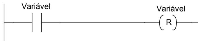
Figura 6.8 - Diagrama escada para a estrutura de *reset*.
