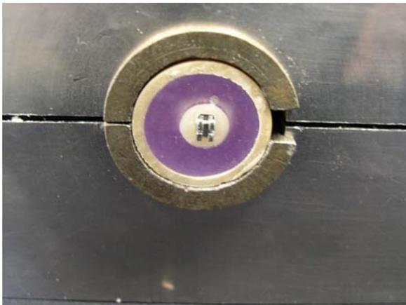
**FIGURA 5** - Posicionamento do corpo-de-prova na luva metálica para início do ensaio mecânico
