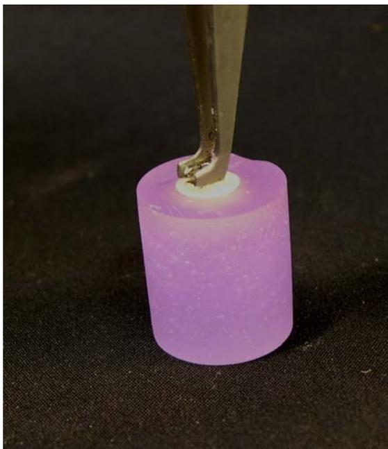
**FIGURA 3** - Posicionamento do *bracket* com auxílio de pinça de apreensão
