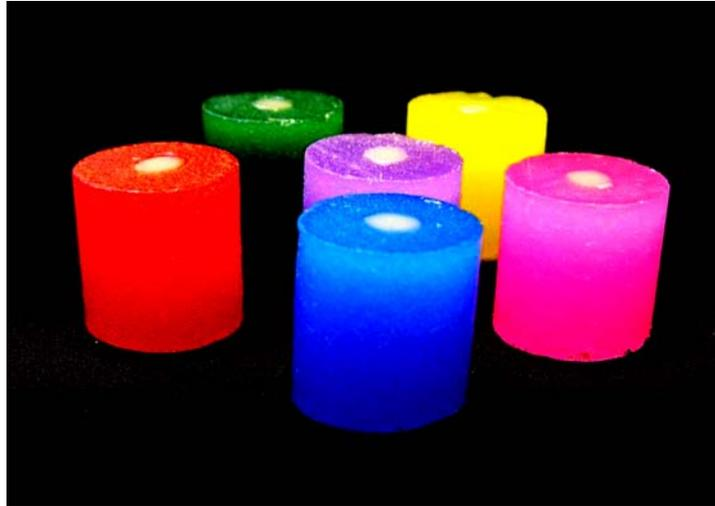
**FIGURA 2** – Amostras cerâmicas embutidas em resina poliestirênica
