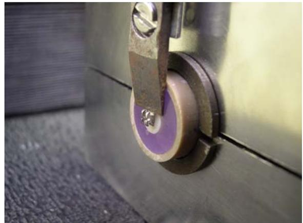
**FIGURA 6** - Posicionamento do cinzel sobre o corpo-de-prova
