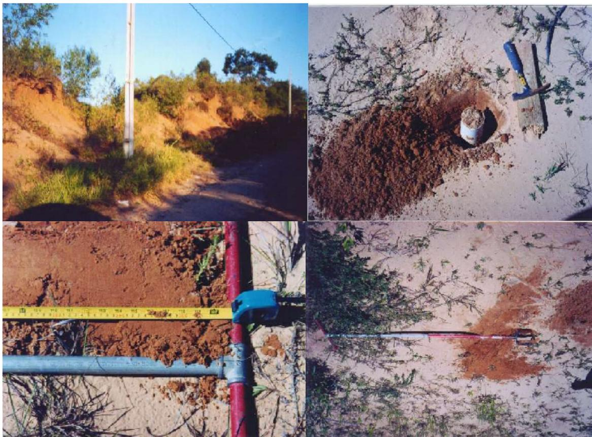
Figura 14: Ensaio de campo e coleta de material para ensaio de permeabilidade em laboratório. Praia do Campeche, Florianópolis, 2002. Fotos: do Autor.
