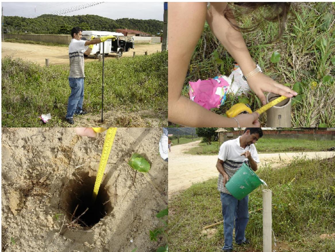
Figura 13: Execução de ensaio de permeabilidade em campo visando também a determinação do nível freático da água subterrânea. Praia Brava, Itajaí, SC, 2005. Fotos: do Autor.
